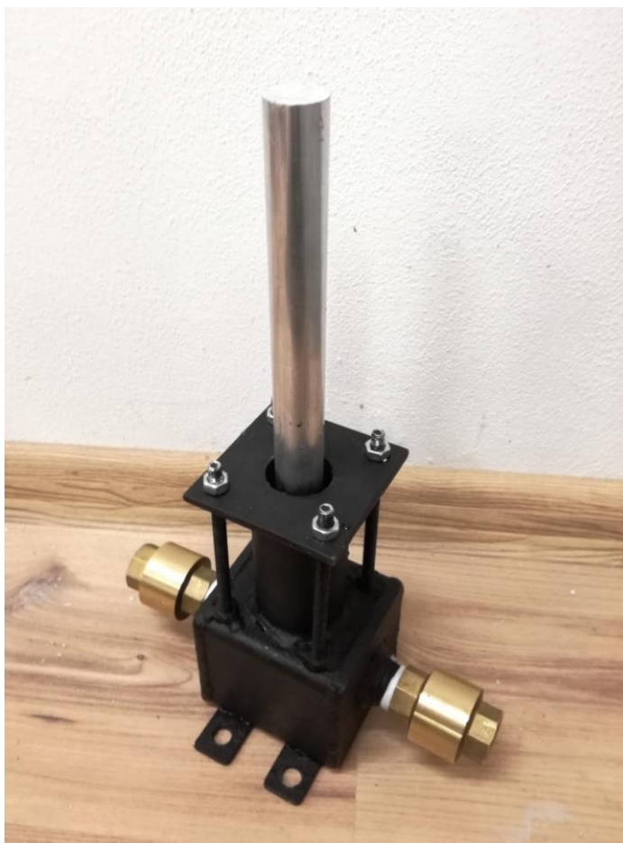
Obr. 33: Svařené čerpadlo se zpětnými klapkami
