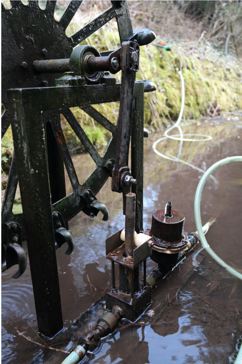
Obr. 35: Namontované čerpadlo v provozu
