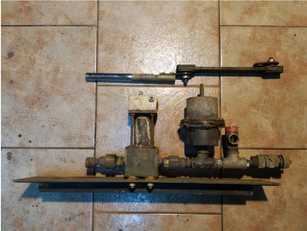
Obr. 34: Čerpadlo po tři čtvrtě roce provozu
