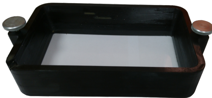
Obrázek 3.10: Vana na fotopolymer s průhledným dnem
