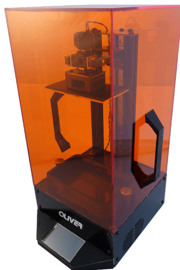
Obrázek 3.35: Realizovaná verze ochranného krytu z plexiskla (varianta b)
