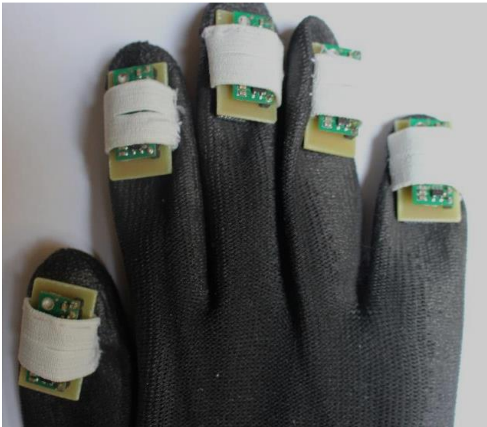
Obrázek 101: Rukavice s vloženými akcelerometry
