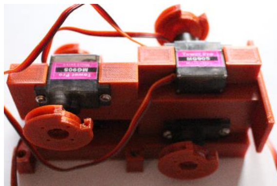
Obrázek 38: Kolečka nasazená na servomotorech
