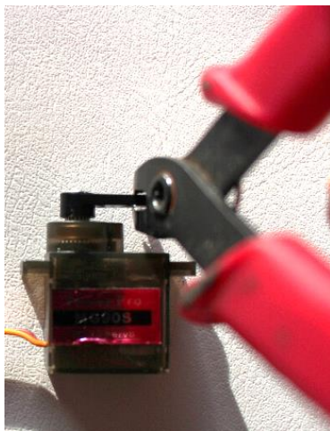
Obrázek 22: Ustřížení části unašeče
