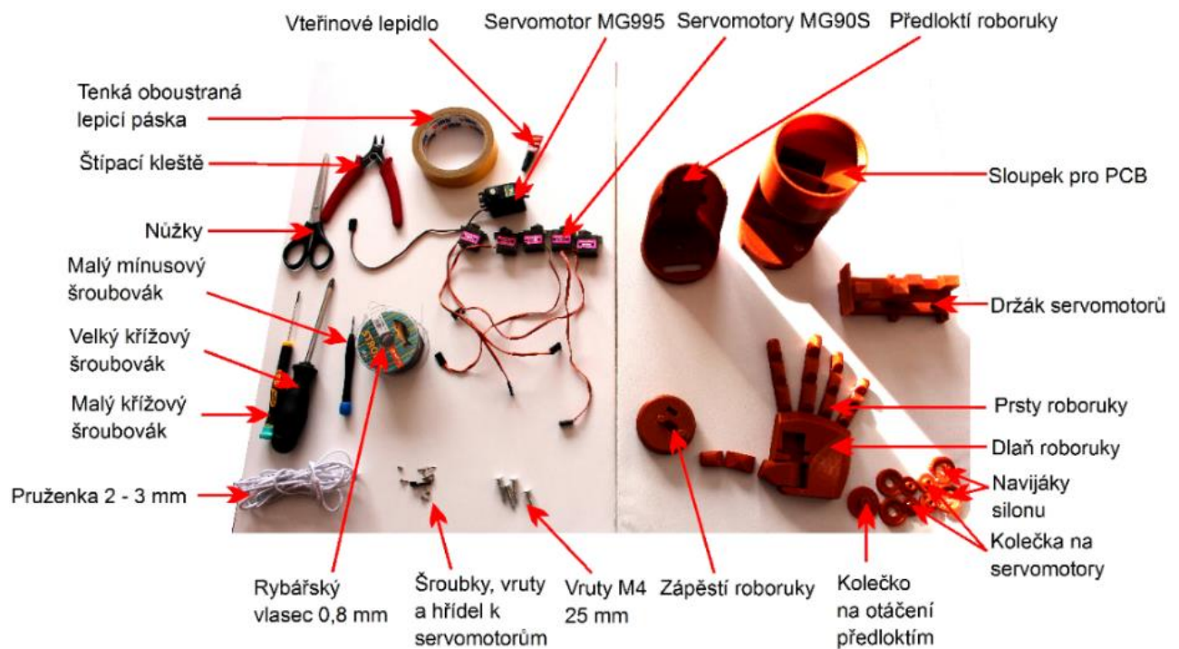
Obrázek 15: Potřebné komponenty ke stavbě mechanického modelu robotické ruky
