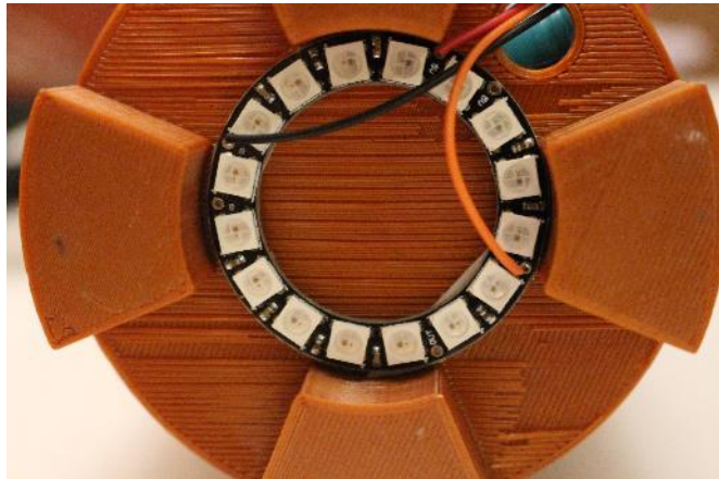
Obrázek 65: RGB LED kroužek přilepený zespod robotické ruky
