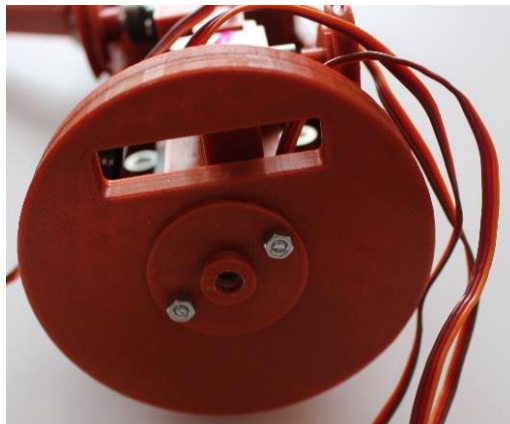
Obrázek 51 : Přišroubování kolečka pro otáčení předloktím k předloketnímu dílu
