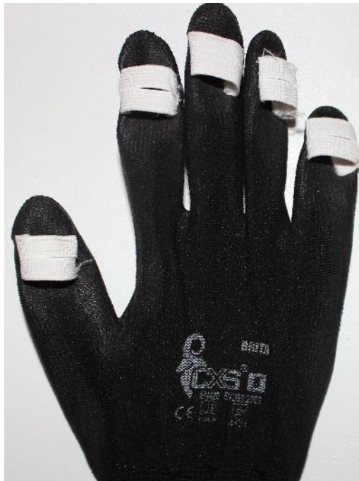
Obrázek 100: Rukavice s přišitými kapsami na akcelerometry
