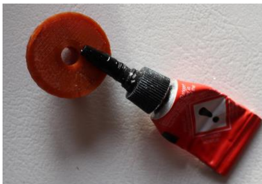
Obrázek 35: Nanesení lepidla na kolečko pro servomotor
