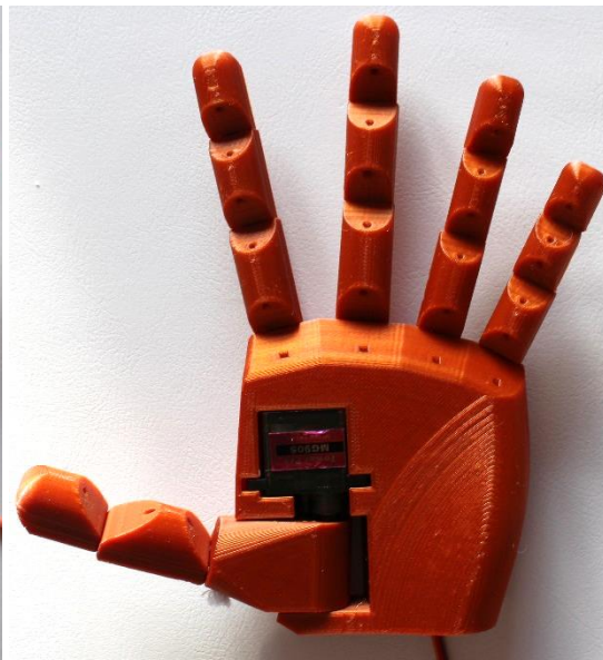
Obrázek 28 a Obrázek 29: Vložení servomotoru do otvoru v dlani
