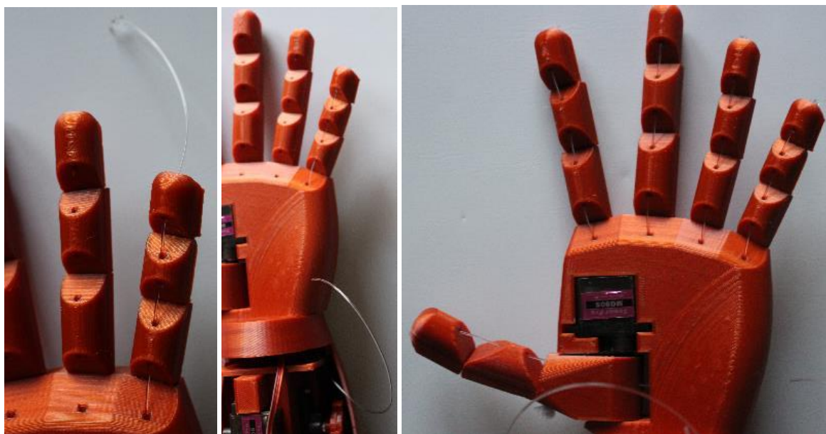
Obrázek 42, Obrázek 43 a Obrázek 44 : Provlečení silonu články prstů
