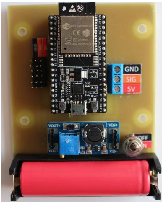
Obrázek 62: DPS robotické ruky s ESP32
