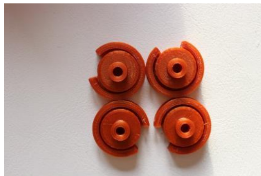
Obrázek 36: Přilepení koleček k navijákům silonu
