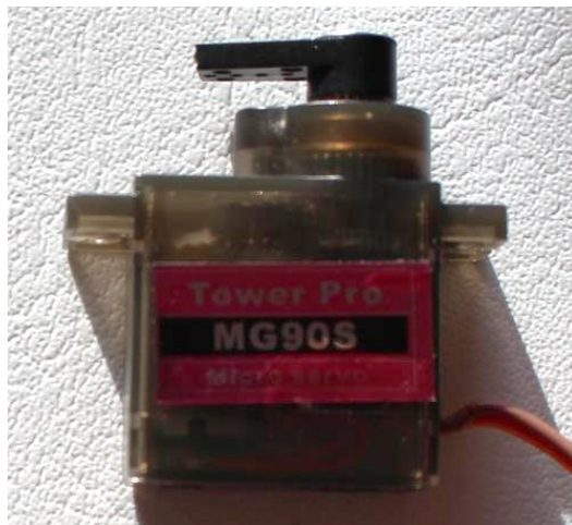
Obrázek 23: Servomotor s ustříženou částí unašeče
