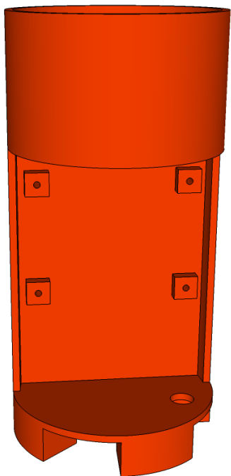
Obrázek 12: Model držáku elektroniky
