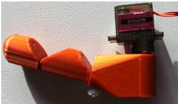
Obrázek 25: Vložení servomotoru do otvoru na palci
