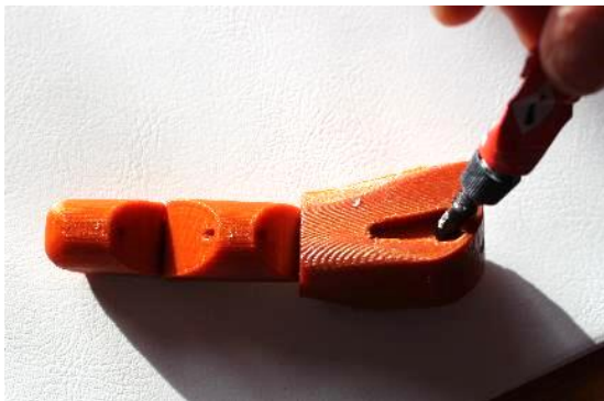
Obrázek 24: Nanesení lepidla do otvoru na palci
