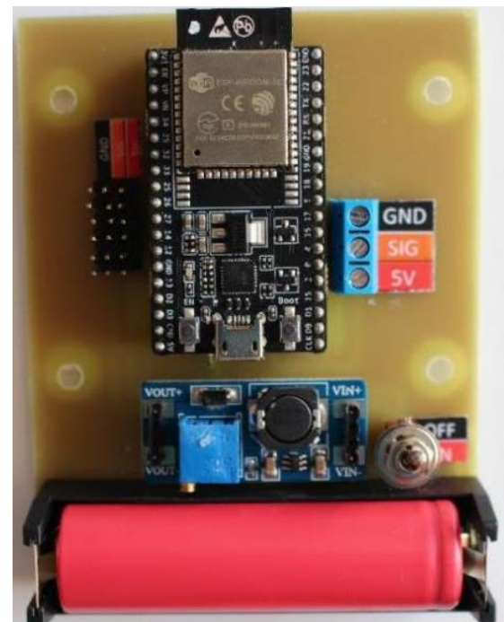
Obrázek 57: Foto DPS robotické ruky – strana součástek
