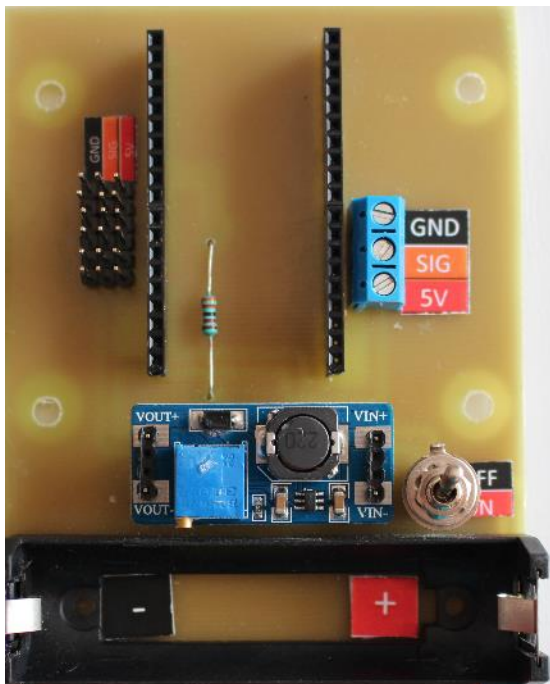
Obrázek 61: DPS robotické ruky bez ESP32
