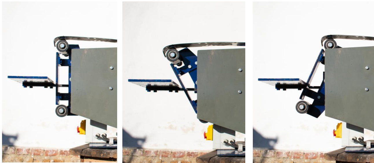
Obrázek 14 Nastavení úhlu brusné hlavy
