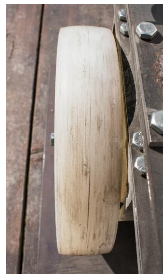
Obrázek 16 Zaoblení hnacího kola
