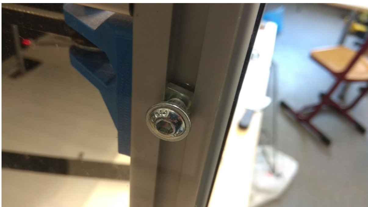
58. Spojení plexiskla s profilem čtvercovou maticí a šroubem
