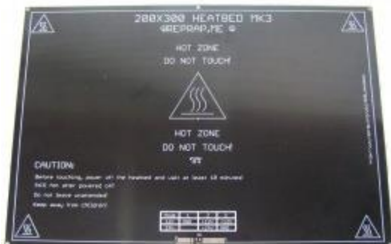
26. Vyhřívání podložka – plošný spoj
