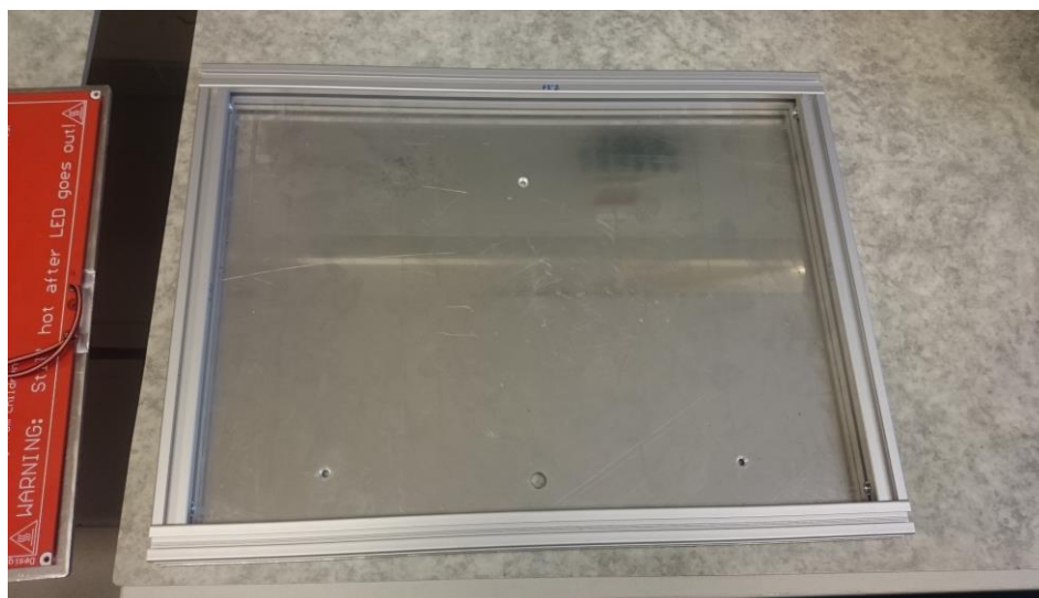
63. Montáž stolu – ustavovací deska s Al profily
