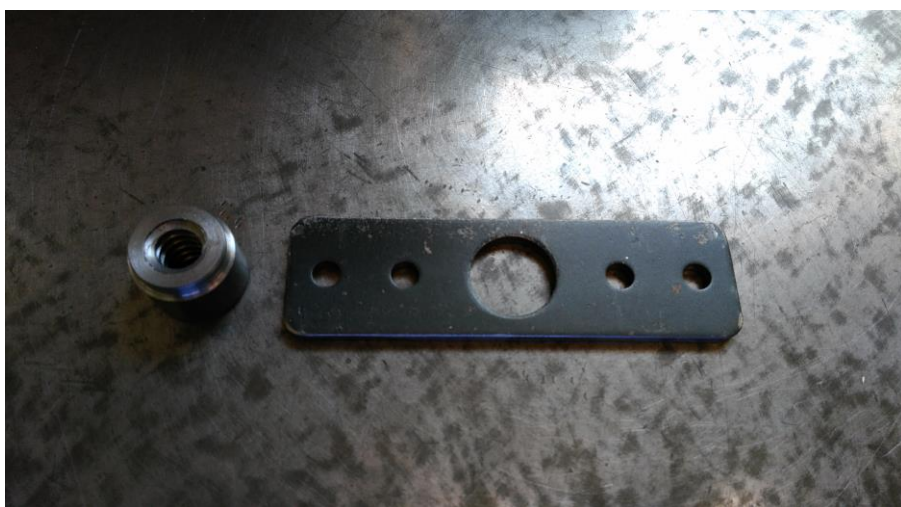
66. Odsazená trapézová matice a plechový přípojovací díl
