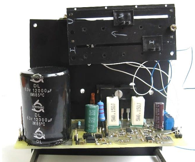
Obrázek 13 Modul lineární stabilizace řízený potenciometrem a připevněný na zkušební chladiči
