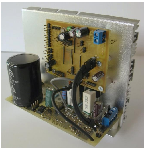
Obrázek 15 Řídicí deska propojená s výkonovou částí
