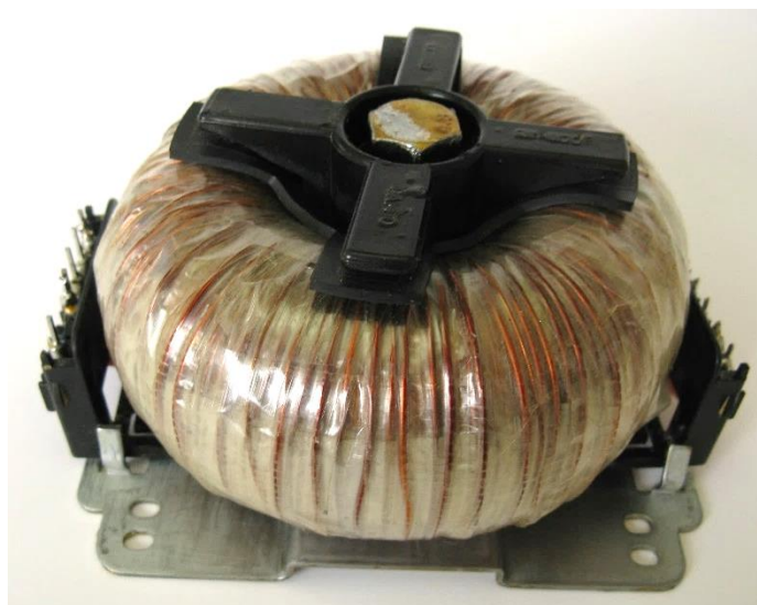
Obrázek 4 Použitý síťový transformátor
