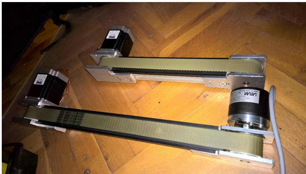
Obrázek 12: Jednotlivé dopravníky s motory
