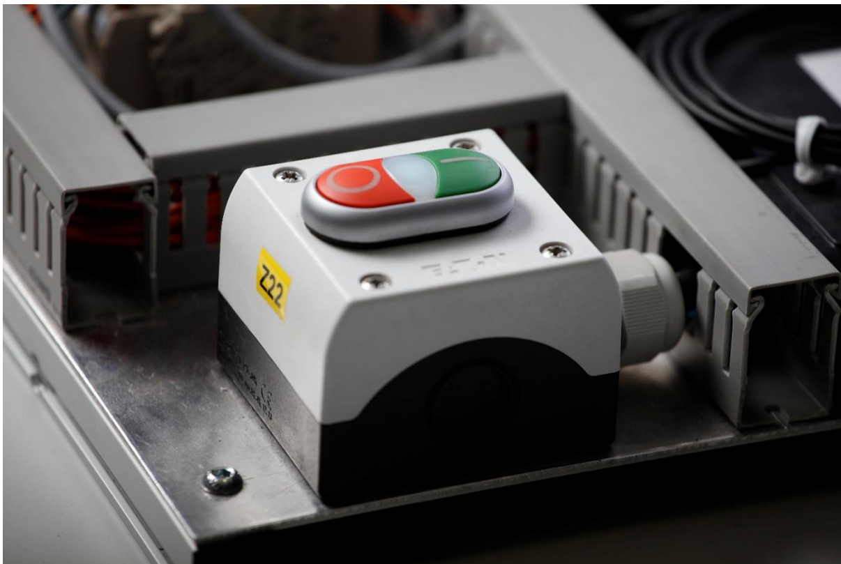
Obrázek 182: Zapínací tlačítka silové části
