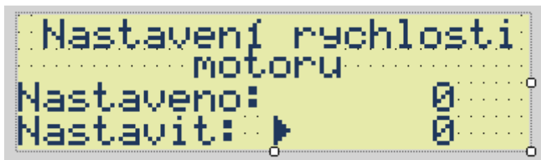
Obrázek 75: Obrazovka nastavení rychlosti motoru
