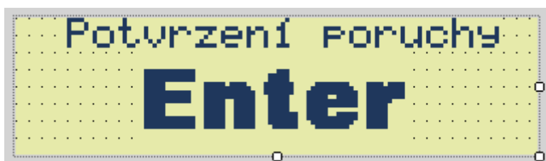
Obrázek 137: Obrazovka potvrzení poruchy
