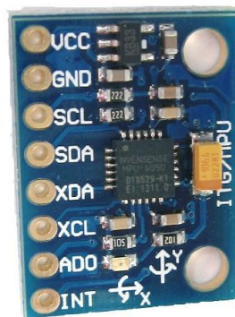
obr. 3 – MPU-6050, zdroj: http://playground.arduino.cc/uploads/Main/mpu-6050.jpg
