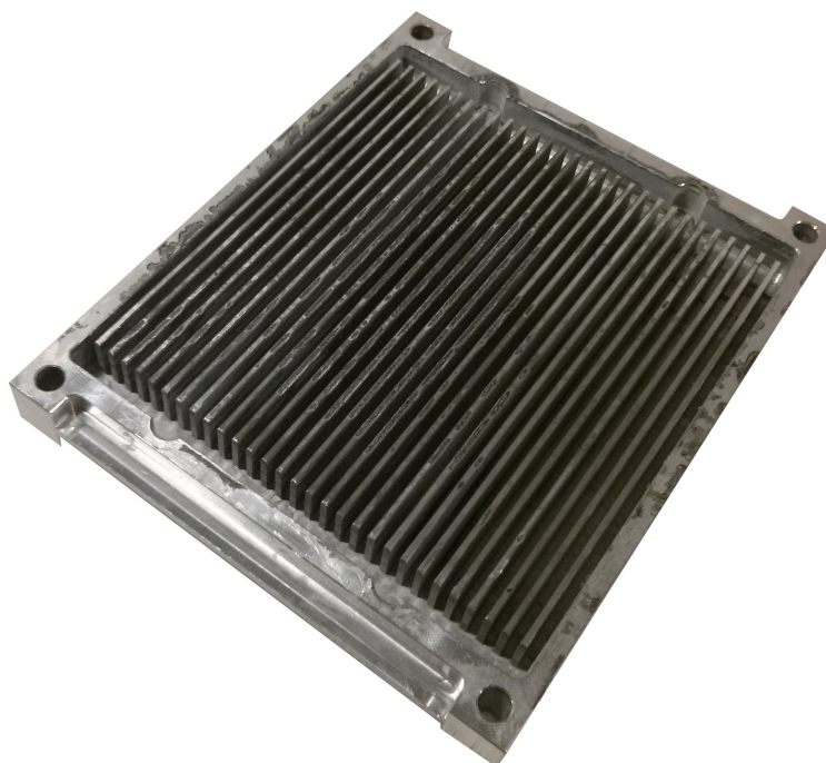
Obrázek A.4: Vyfrézovaný hliníkový chladič (již použitý – je pokryt vrstvou oxidu hlinitého)
