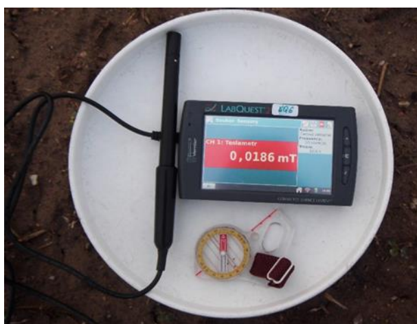
Obr. 17 Měření teslametrem v horizontální poloze. Teslametr míří severojižním směrem (viz štrelka buzoly).
