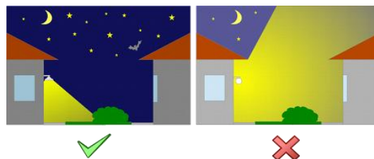
Obr. 6 - Správné a nesprávné směřování světla zdroj: http://svetelneznečistení.cz/
