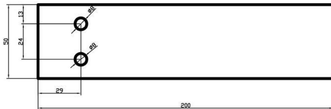
Obr. 31: Technický výkres bočního panelu.
