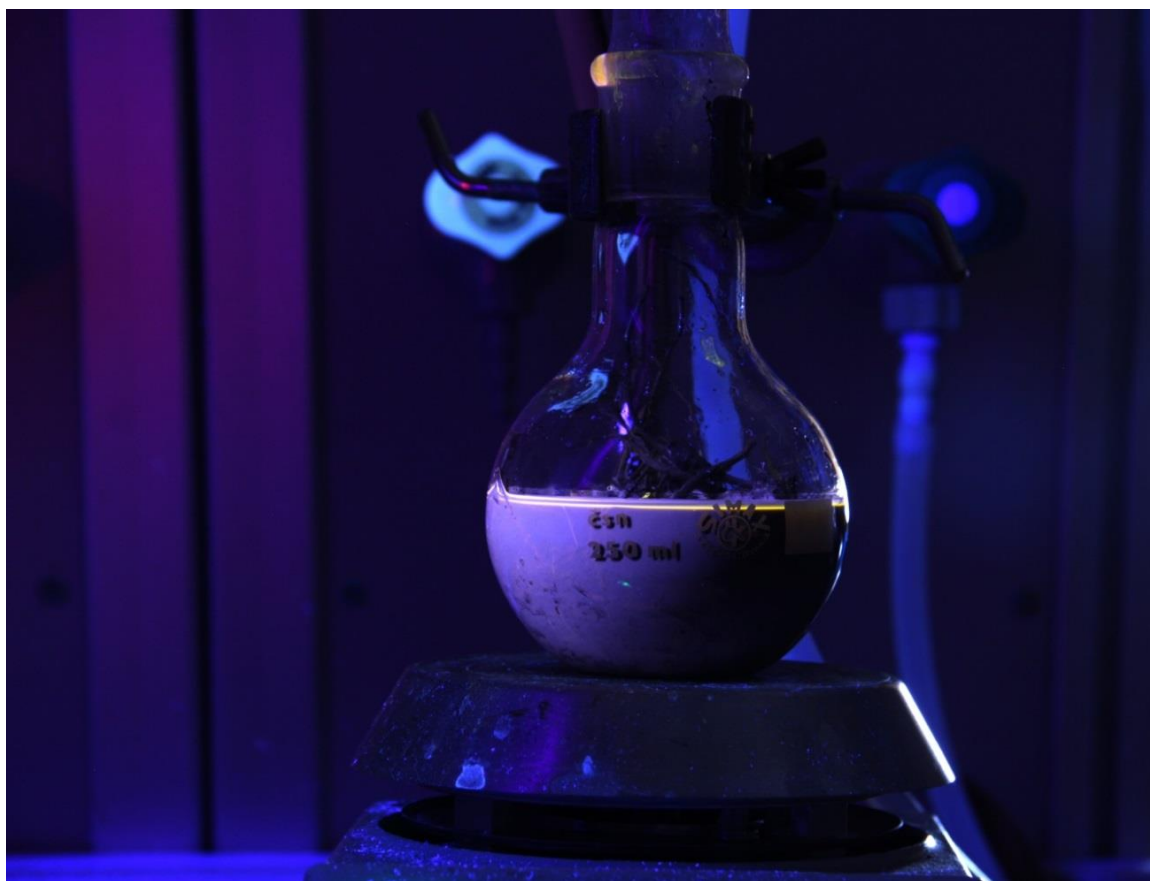
Obrázek 34: Oranžová fluorescence na hladině baňky je způsobena berberinem a jemu příbuznými alkaloidy.
