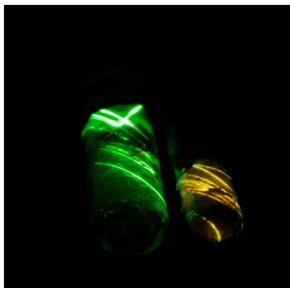
Obrázek 50: Tavenina fluoresceinu v kyselině borité při pokojové teplotě (vlevo) a po vyjmutí z chladicí směsi se suchým ledem (vpravo). K excitaci byl použit modrý laser.
