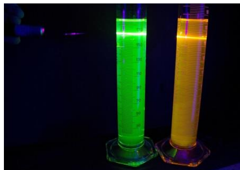
Obrázek 19: Srovnání fluorescence fluoresceinu (vlevo) a eosinu (vpravo).
