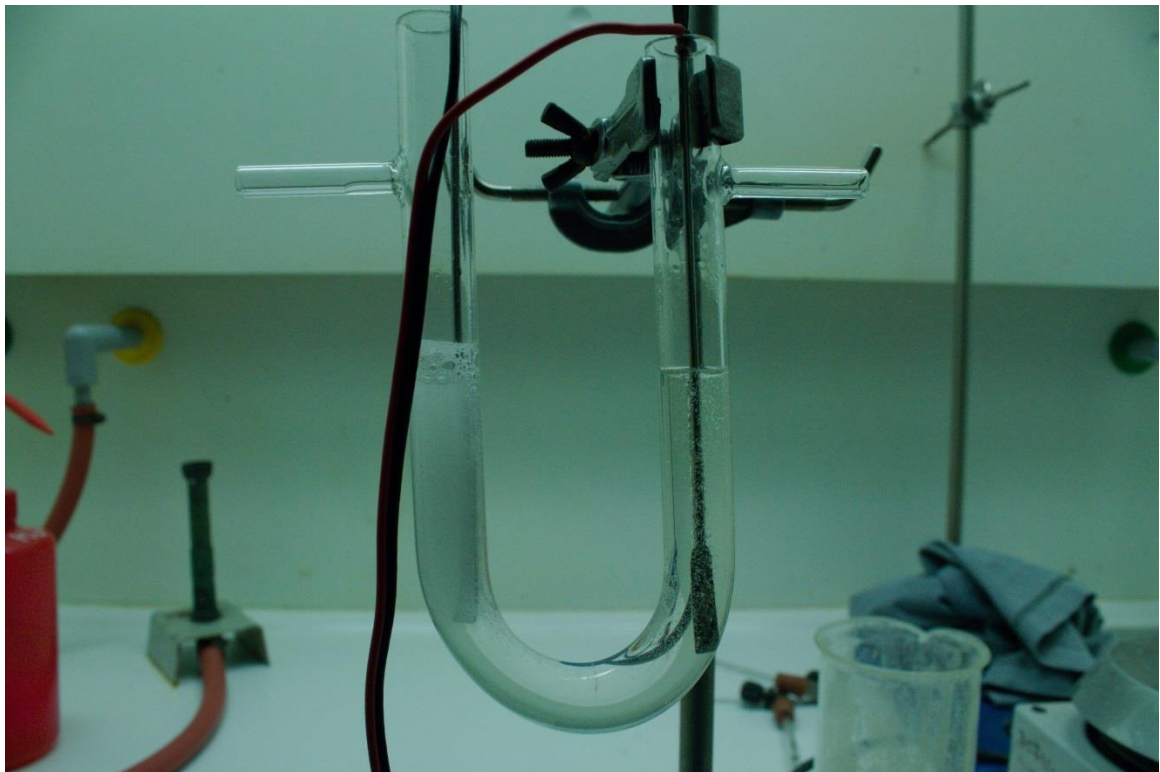
Obrázek 84: Aparatura na elektroluminiscenci za běžného osvětlení. Katoda vlevo (vznikají bublinky vodíku) anoda vpravo (vzniká kyslík).
