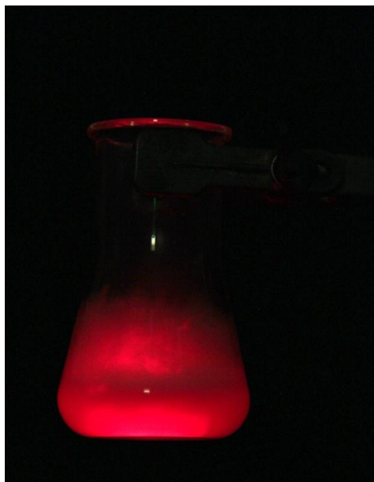
Obrázek 73: Chemiluminiscence s kyselinou trichlorisokyanurovou.
