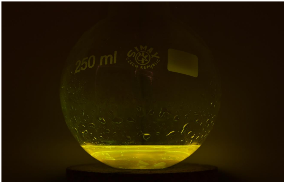
Obrázek 88: Chemiluminiscence bis(2,4,6-trichlorofenyl) oxalátu s eosinem.
