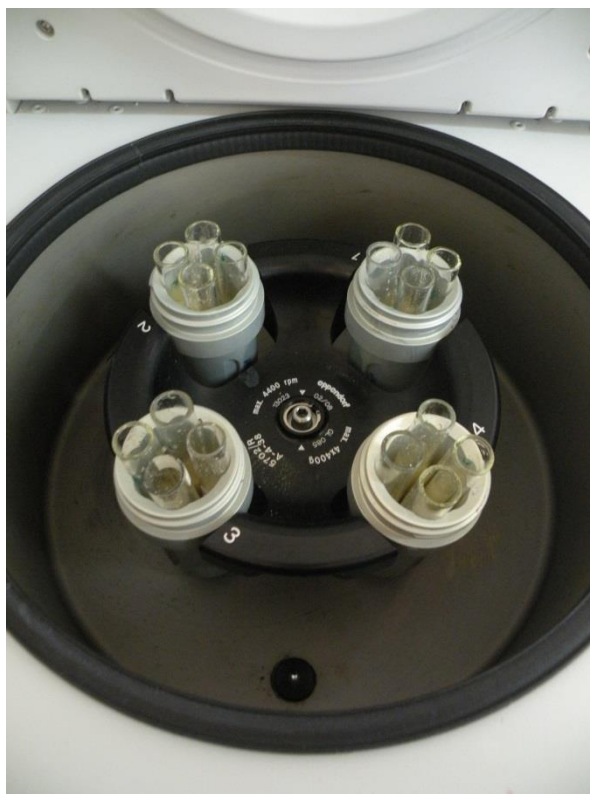
Obr. č. 27: Zkumavky vložené do centrifugy
