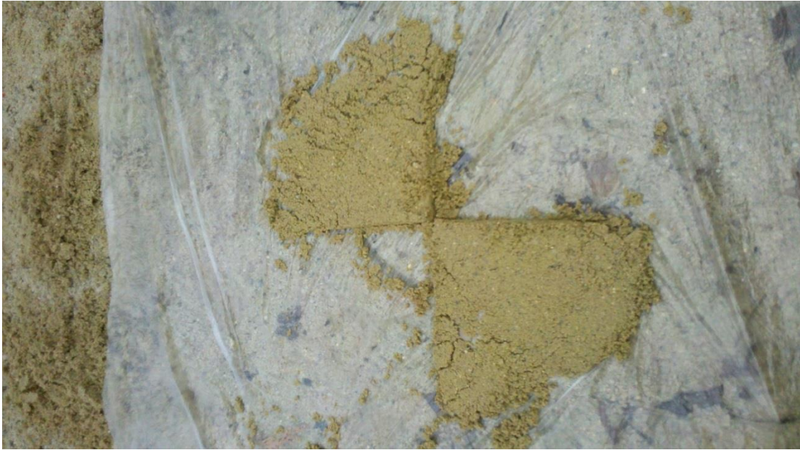
Obr. č. 19: Vzorek po kvartaci
