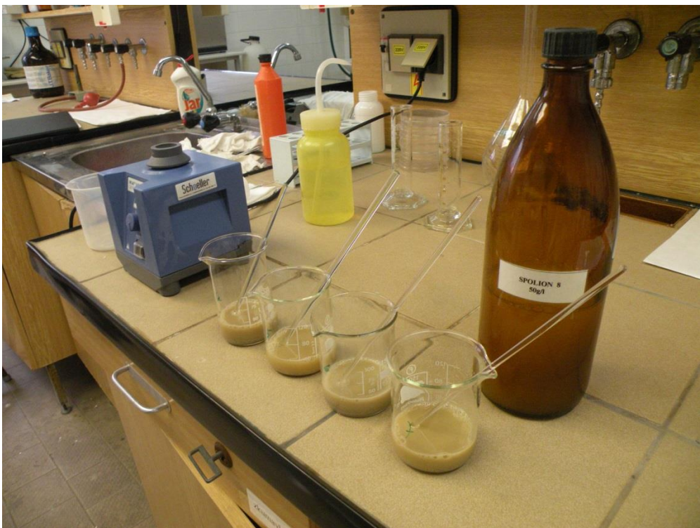
Obr. č. 22: Vzorek se Spolionem a destilovanou vodou
