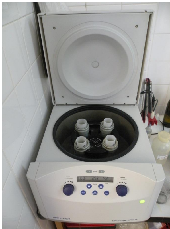
Obr. č. 25: Centrifugační nádoby v centrifuze
