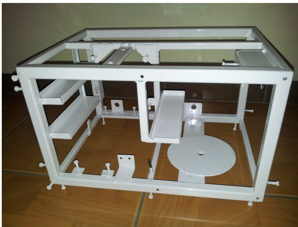
Obr. 24 Skříň zdroje po nastříkání práškovým lakem bílé barvy (otvory s vyříznutými závity byly v průběhu práškování kryté šrouby)
