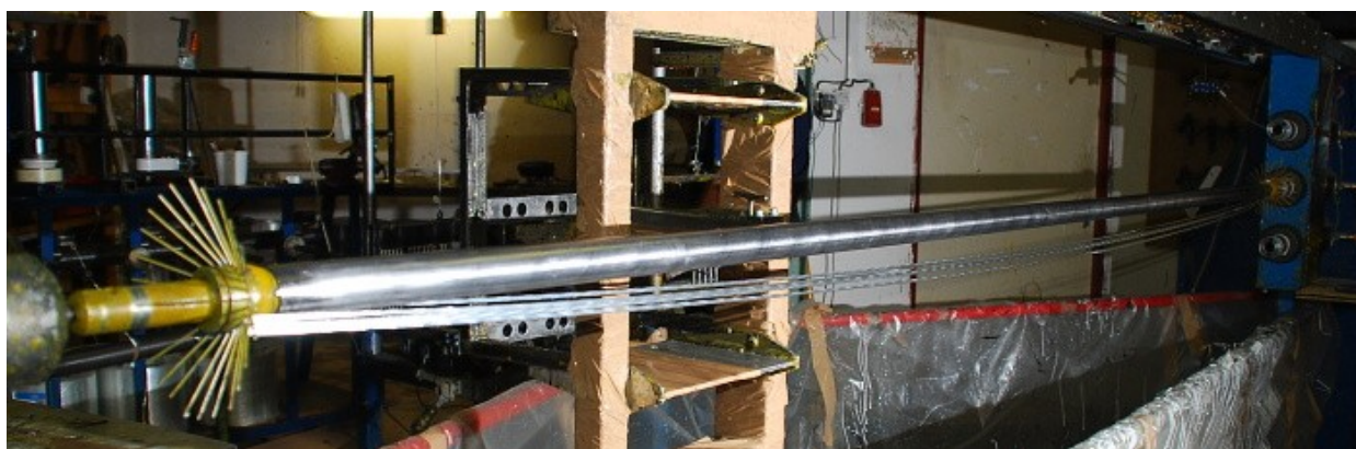
Obr. 7: Průhyb podélného vlákna (zdůrazněn nízkou napínací silou)
