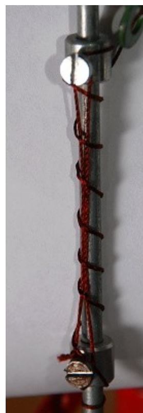
Obr. 5: Navíjení „napříč“ - úhel 45°
