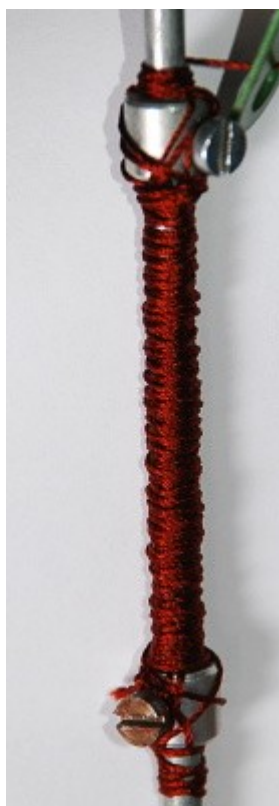
Obr. 4: Těsné navíjení - úhel 90°
