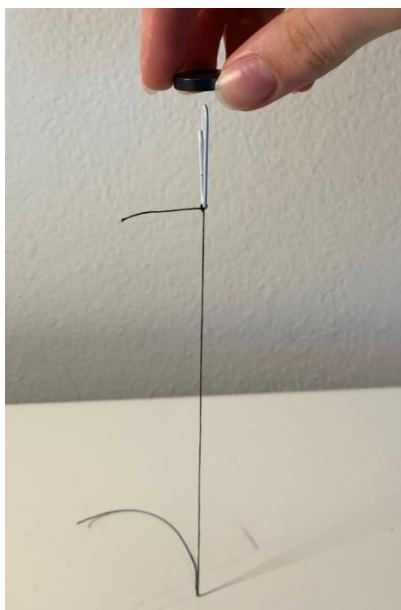
Obrázek 12 - Kancelářská sponka „levitující“ pod magnetem
