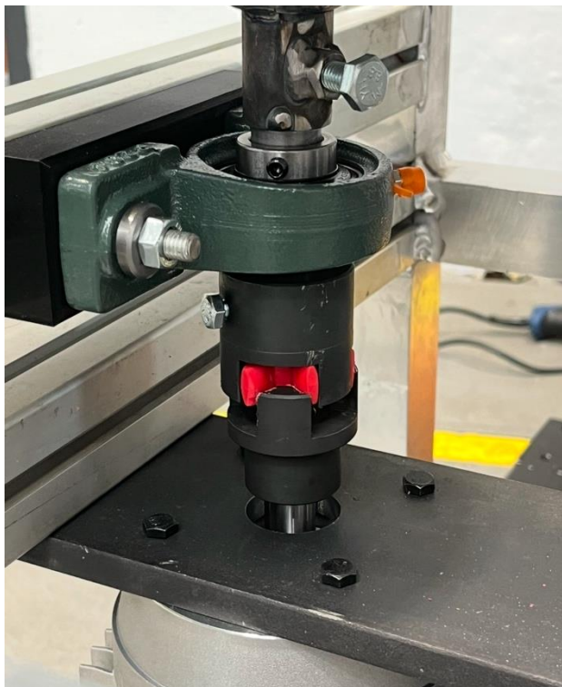
Obrázek 10: Pružná spojka v průběhu testování
