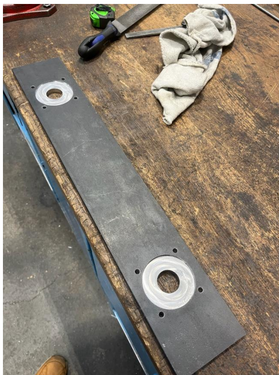
Obrázek 14: Vyfrézované zámky v pásovině
