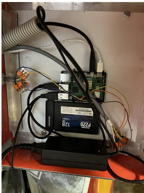
Obrázek 22: Uložení elektroniky ve stíněném boxu
