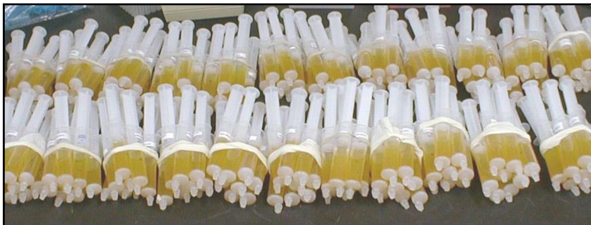
Obrázek 7: Paralelní syntéza většího počtu peptidů v polypropylenových stříkačkách.
