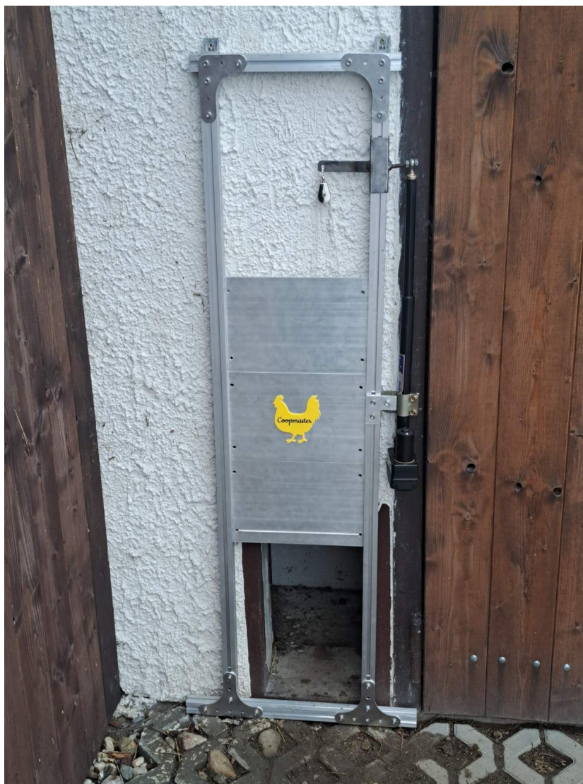
Obrázek 4.16: Instalovaný prototyp dvířek Zdroj: [Autor]
