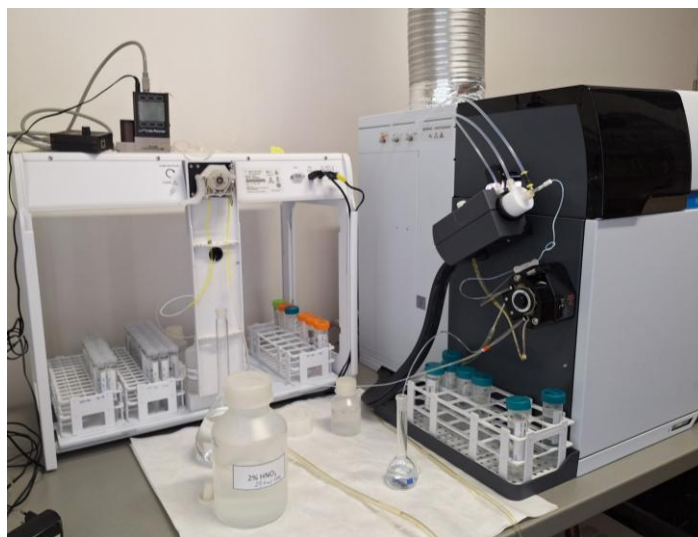
Obrázek 8: Přístroj Agilent 7900 ICP-MS použitý pro analýzu koncentrace těžkých kovů metodou hmotnostní spektrometrie s indukčně vázanou plazmou (ICP-MS). Foto: Natalie Salem.
