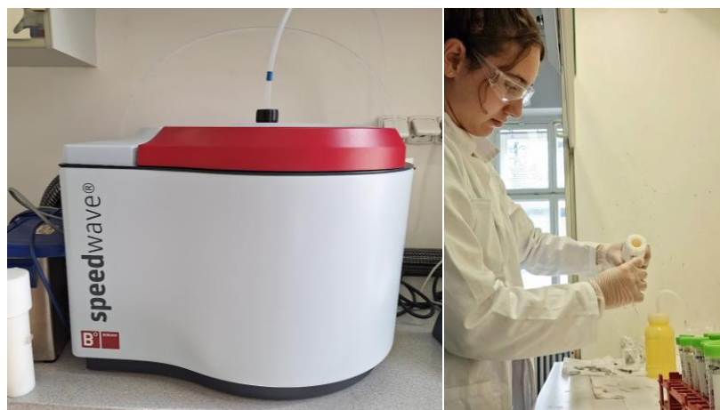
Obrázek 7: Vlevo tlakové mikrovlnné rozkladné zařízení Speedwave Xpert použité pro digestci vzorků. Vpravo ředění vzorků po digestci pro následnou analýzu metodou ICP-MS. Foto: Natalie Salem.
