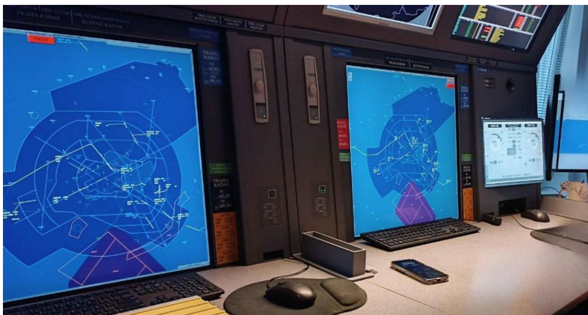
Obr. 1: ATC simulátor na ČVUT FD zachycený během simulace stanoviště APP pro letiště Václava Havla v Praze, kde si studenti procvičují standardizovanou frazeologii, koordinaci přiletů a odletů a interakci mezi ATCos a pseudopiloty v realistickém prostředí.
