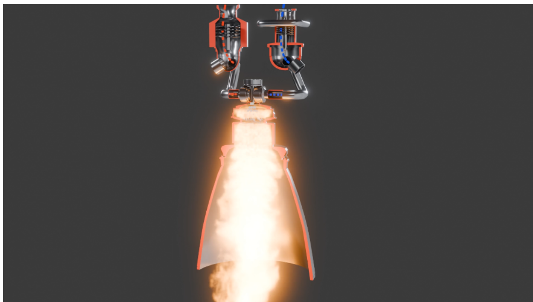
Obr. 27 – Model raketového motoru na kapalné palivo Rocketdyne J-2 [obrázek autor]
