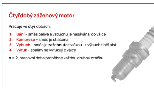
Obr. 43 – vlevo: Obrázek svíčky u vysvětlení čtyřdobých zážehových motorů [obrázek autor]
