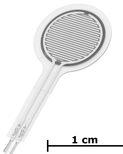
Obrázek 2.2: Piezorezistivní čidlo ([8], upraveno)
