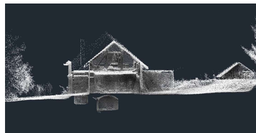
Obrázek 10: Příčný řez mračenem bodů pro zobrazení všech podlaží RD
