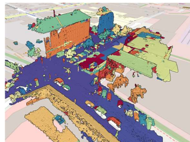
Obrázek 18: Automaticky analyzované mračno bodů za pomoci Pointly.ai a dat z Demo účtu Pointly.ai
