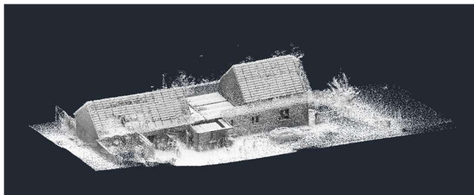
Obrázek 7 : 3D laserový sken RD vytvořený se skenerem GeoSLAM.
