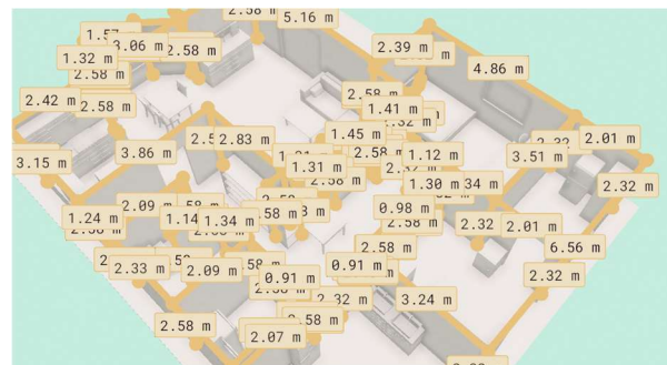
Obrázek 16: Automatické okótování 3D půdorysu
