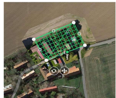
Obrázek 2: Naplánovaná trasa přeletu dronu nad objektem v aplikaci DroneDeploy
