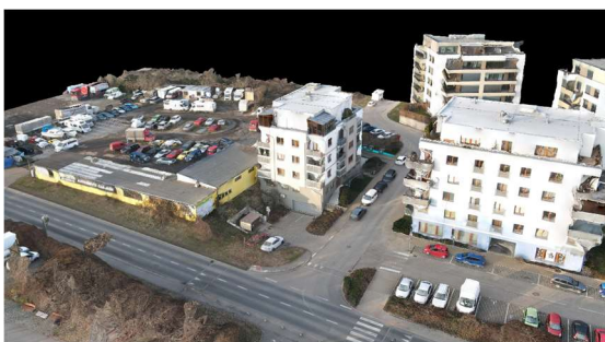
Obrázek 3: 3D model vytvořený za pomoci fotogrametrie a softwaru DroneDeploy
