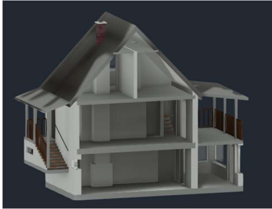
Obrázek 25: 3D model budovy vytvořený a připravený pro export do .ifc formátu
