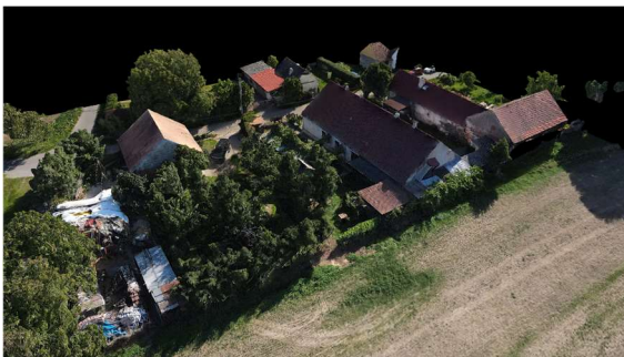
Obrázek 1: Model objektu vytvořený za pomoci fotogrametrie a softwaru DroneDeploy.
