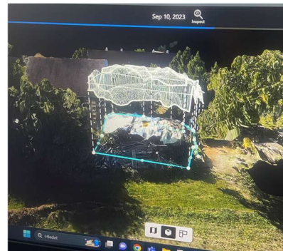
Obrázek 40: Změření kubatury materiálu, zde bylo měřeno množství dřeva. Ve webovém rozhraní DroneDeploy.
