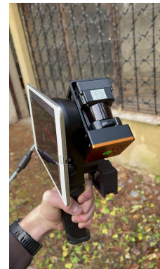
Obrázek 8: 3D laserový skener GeoSLAM ZEB-GO
