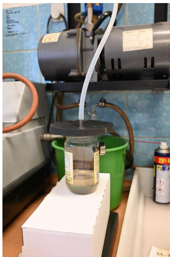
Obrázek 14: Schéma sestavení aparatury pro vakuové napouštění vzorků. Foto: P. Pernický, 2024.
