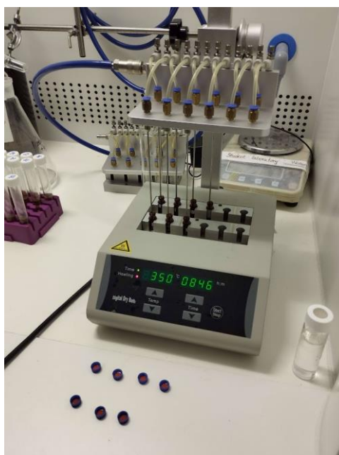
Obr. č. 36: Odpařování vzorku pod proudem dusíku v koncentrátoru ; Foto: autoři
