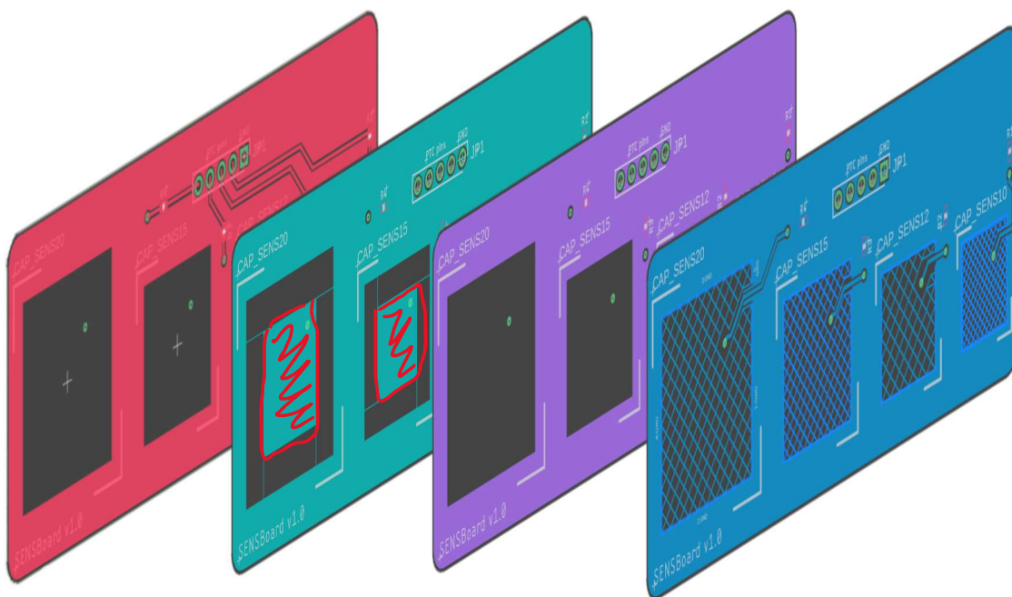
Obrázek 42: Jednotlivé vrstvy prototypovací desky pro kapacitní senzory s červeně vyznačenými částmi, které byli po výrobě zjištěni, že chybí
