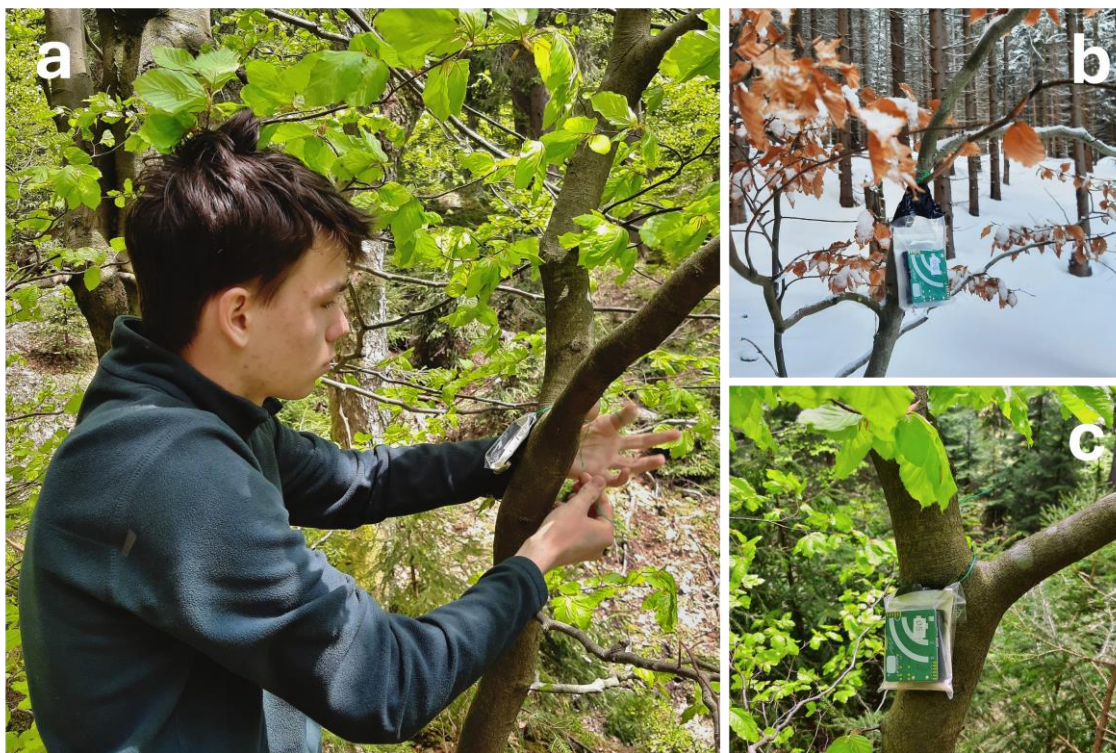
Obrázek 7: Umístění záznamníků. Fotografie „a“ ukazuje způsob umístění záznamníků na mladý buk. Na fotografii „b“ je umístěný záznamník na konci února a na fotografii „c“ je záznamník z konce května.
