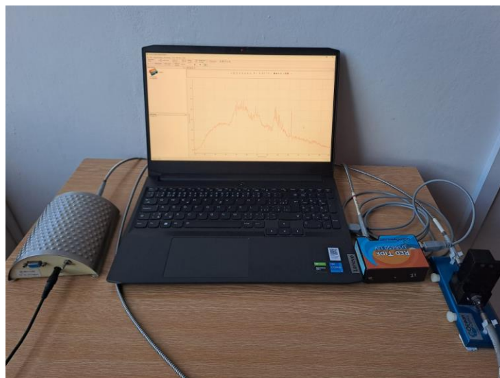
Obr. 2.3 – Soustava pro měření s Red Tide USB650 UV (popis obrázku: vlevo zdroj záření deuterium halogen, vpravo spektrometr Red Tide s držákem na kyvety, celá soustava propojená křemennými optickými vlákny)
