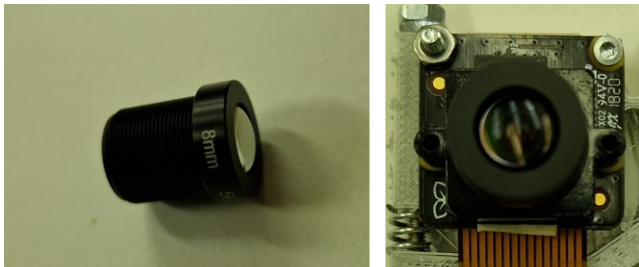
Obr. 3.21 – Objektiv závitu M12 s ohniskovou vzdáleností 8mm (vlevo) a PiCamera V2 s nasazeným M12 objektivem (vpravo)
