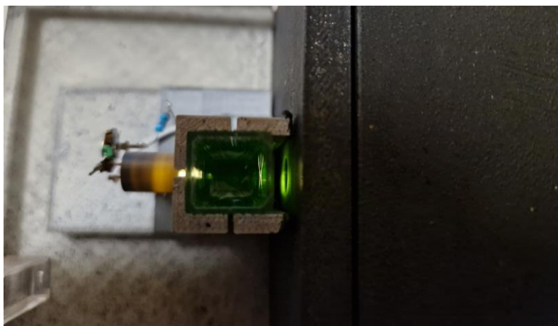
Obr. 3.15 – Analýza vzorku v kyvetě pomocí bílé LED diody jako zdroje
