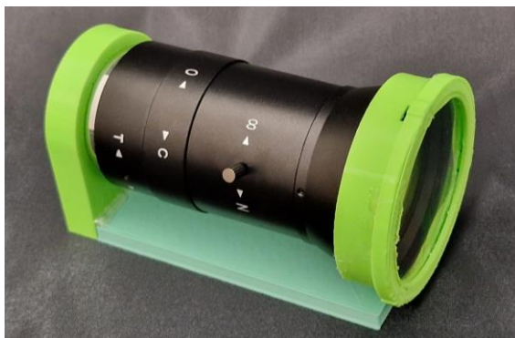
Obr. 3.67 – Sestrojený kolimátor s difrakční mřížkou
