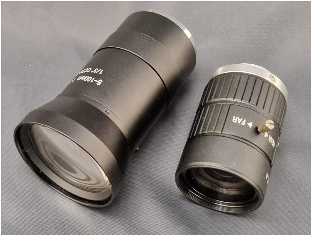
Obr. 3.22 – Větší objektivy závitu C s variabilní ohniskovou vzdáleností
