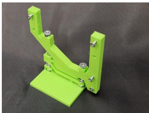
Obr. 3.70 – 3D tisknutý úchyt pro desku lineárního senzoru na nastavitelné platformě
