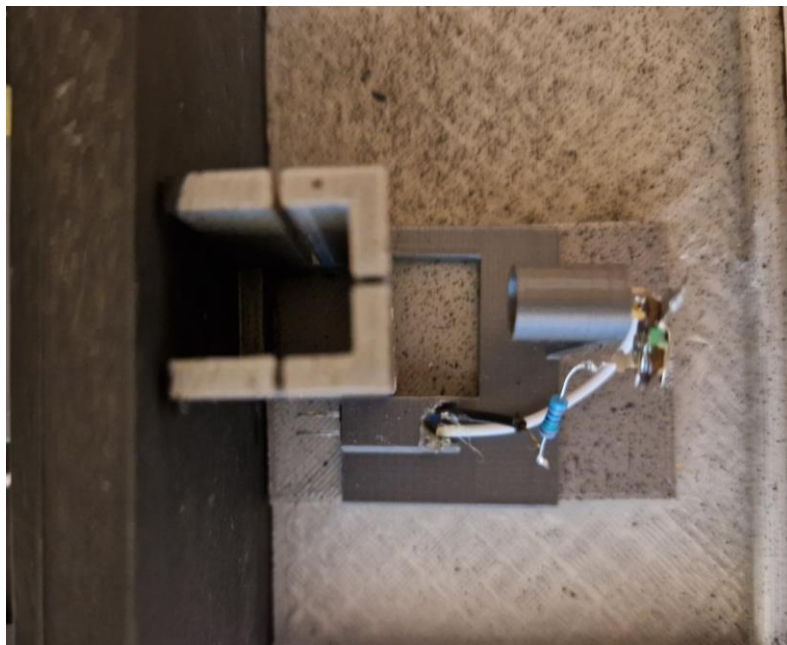
Obr. 3.14 – Držák kyvety používaný ve spektrofotometru V2 se štěrbinami pro zdroj
