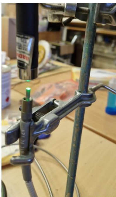
Obr. 3.8 – Využití laserového ukazovátka (532 nm) na kalibraci spektrometru
