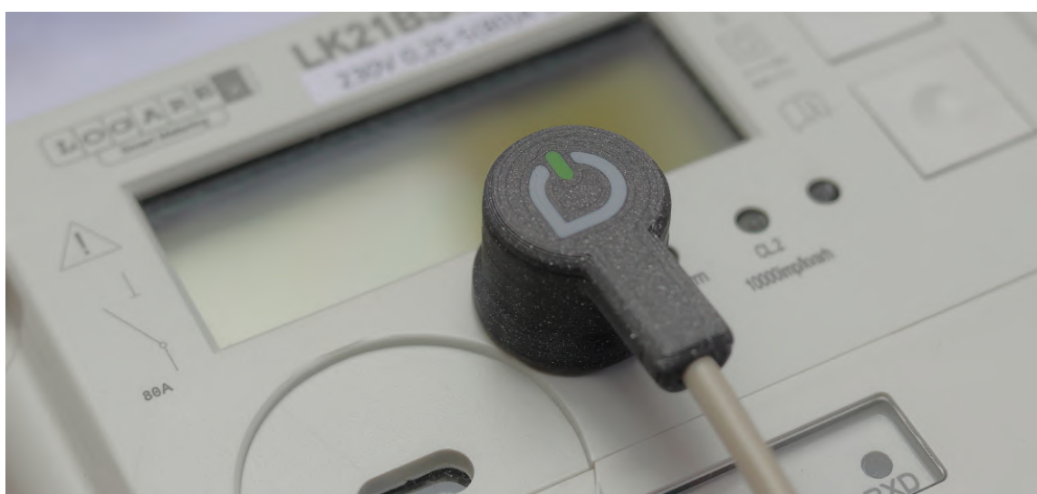
Obrázek 3.5: Krok 3b – sonda zapojená na rozhraní elektroměru s metrologickou diodou
