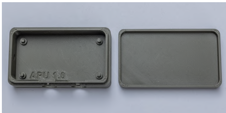
Obrázek 2.9: Ukázka výtisku prototypu krabičky pro APU 1.0
