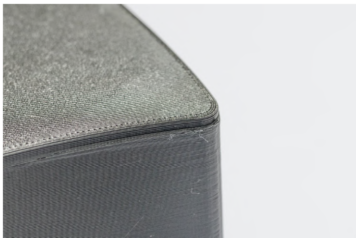
Obrázek 2.11: Ukázka odlepování v rozích krabiček (tzv. warping )
