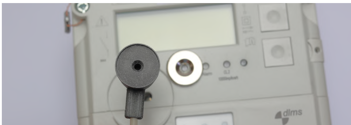
Obrázek 3.4: Krok 3a – upevnění sondy APU na disk na metrologické diodě
