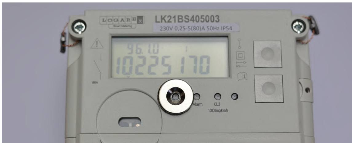
Obrázek 3.3: Krok 2b – nalepený feromagnetický disk na elektroměru
