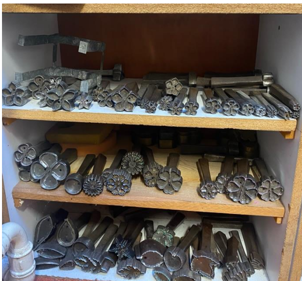
Obrázek 51: Raznice s různými vzory květin, foto: Jola Babadžanjan, 2024
