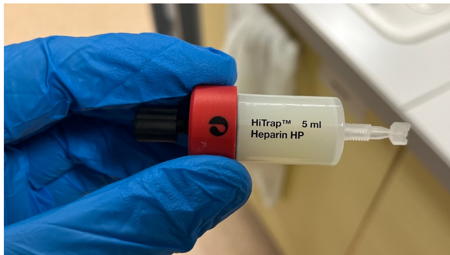
Obrázek 10: Fotografie kolony HiTrap Heparin HP column (Cytiva), použité při obou heparinových afinitních chromatografiích provedených v rámci této práce
