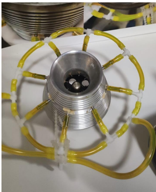
Obrázek 41 Příklad vícebodového vstřikování pro ventilový motor (ČVUT)
