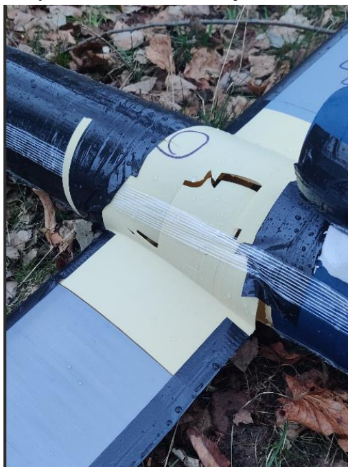
Obrázek 65 Prasklina v trupu po prvním letovém testu D1.1 (kluzáku) (archiv Tc)
