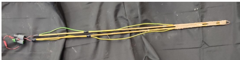
Obrázek 51 Elektrický zapalovač pro statické testy (ke vsunutí do spalovací komory ústím trysky) (Archiv Tc)
