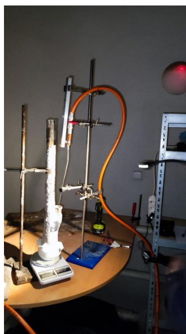
Obrázek 46 (vlevo) Schéma palivové soustavy pro statické testy - palivová lahev, regulátor, později bez ventilu na regulaci tlaku, vstřikovací tryska, teploměry a váhy (Archiv Tc)
