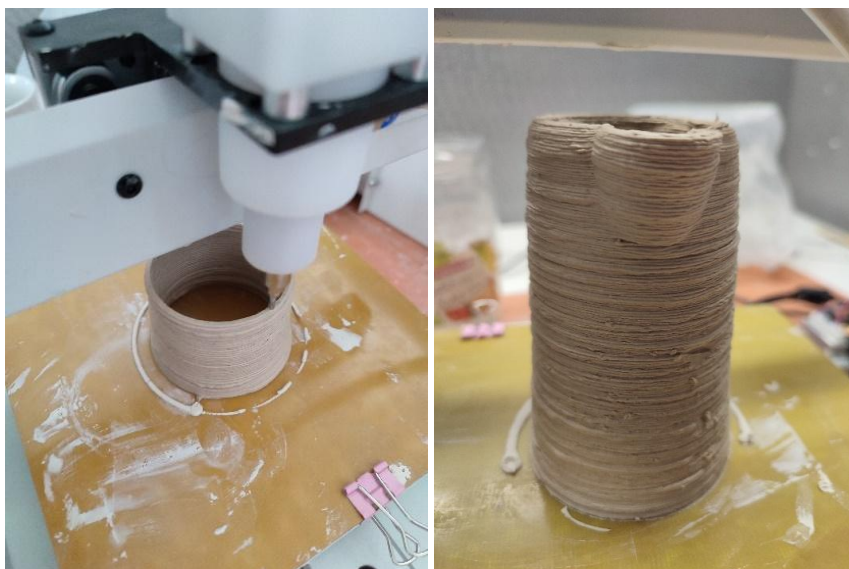
Obrázek 52 (vlevo) Tisk komory aFWE z keramiky s karbonovými vlákny (Archiv Tc)
