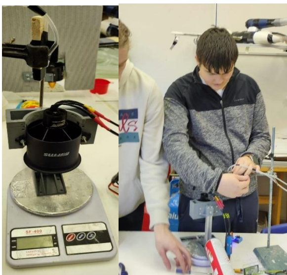
Obrázek 37 (v levo) Příprava testu EDF - příprava pitotovy trubice (Archiv Tc)
