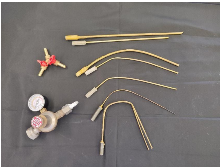
Obrázek 50 dílčí části naší palivové soustavy pro statické testy - vlevo nahoře rozdvójka pro testy FWE VIII, 2. vlevo dole regulátor tlaku, 3. vpravo příklady vyrobených trysek (Archiv Tc)
