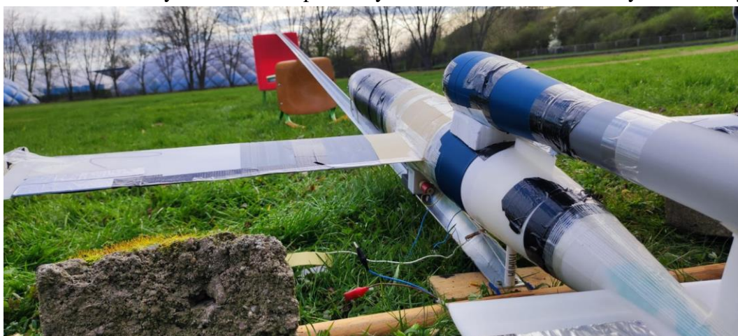
Obrázek 62 Kluzák D1.1 s raketovými motory položený na vozíku připevněný ke startovací rampě katapultu (archiv Tc)
