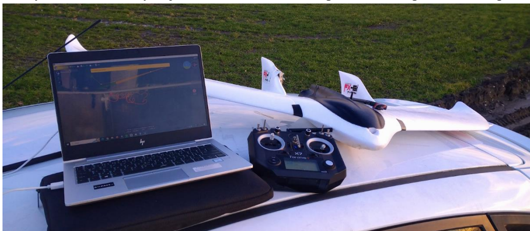
Obrázek 35 testovací letadlo s autopilotem, vysílačkou a počítačem s QgroundControl před letem (Archiv Tc)
