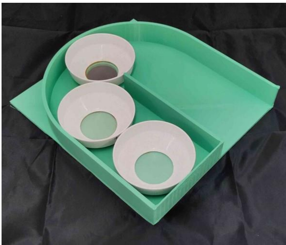
Obr. 25: Prototyp odběrového zařízení na filtraci planktonu
