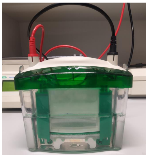
Obrázek 7 Zapojená elektroforetická vana s vloženým gelem (Bio-Rad, USA) [zdroj autor, není-li uvedeno jinak]
