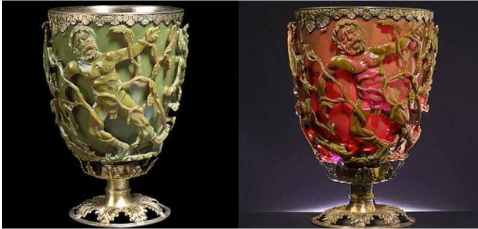
Obrázek 5: Římský pohár ze sodnovápenatého skla obsahující nanočástice zlata a stříbra, převzato z [11]
