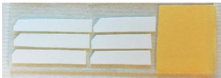
Obrázek 11: PVDF membrány po metodě dot-blot připravené pro analýzu pomocí LA-ICP-MS, vlastní fotografie
