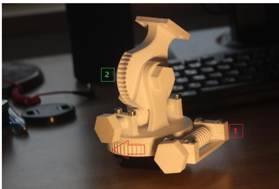
Obrázek 11 První prototyp polárního klínu 1 nastavení azimut, 2 nastavení výšky
