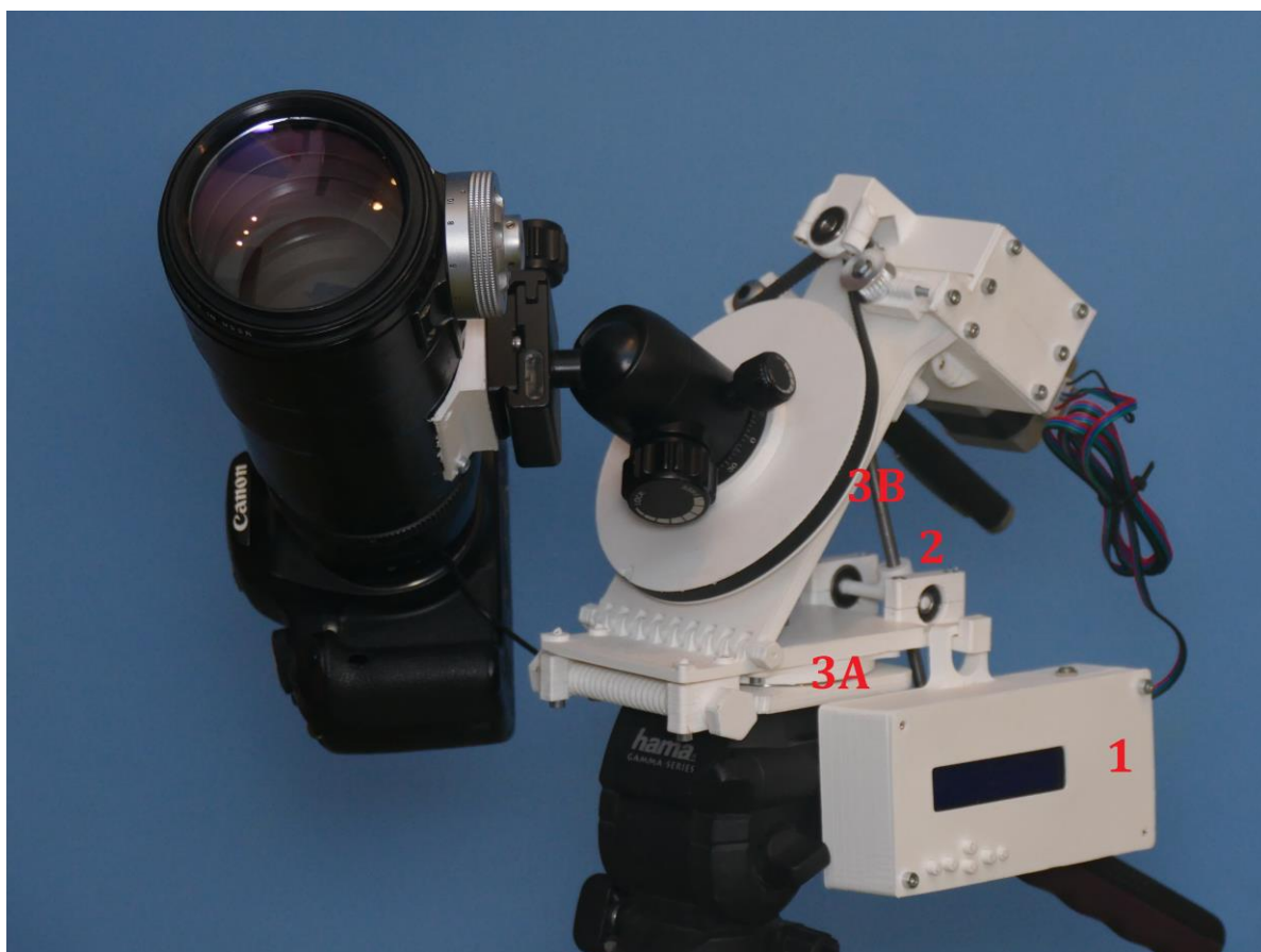
Obrázek 20 Čtvrtý prototyp - 1 Box na elektroniku, 2 Vylepšení nastavování výšky, 3A Vylepšené ložisko v azimutu, 4 Vylepšené ložisko v polární ose
