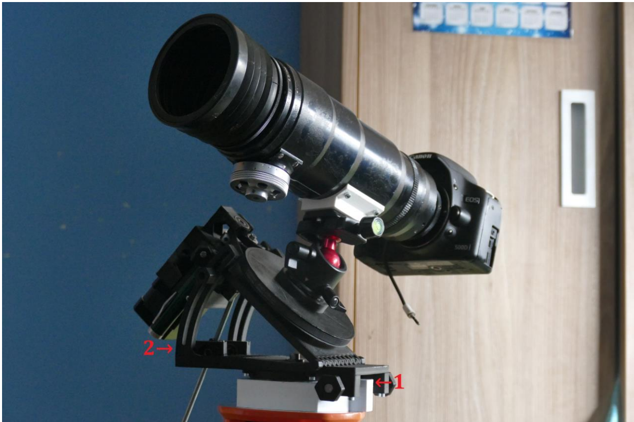
Obrázek 22 Prototyp5 - 1 Vylepšené nastavování azimutu 2 Přidané boční půlkruhy
