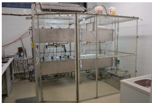
Obrázek 12. Inhalační komora s inhalačními klecemi (foto: Eva Svozilová, DiS.).
