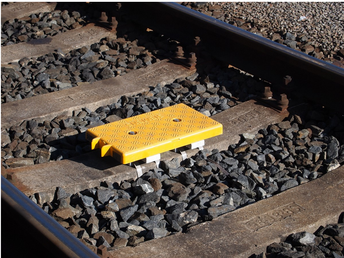
Obrázek 11: Eurobalíza ETCS v kolejšti – traťová část ETCS
