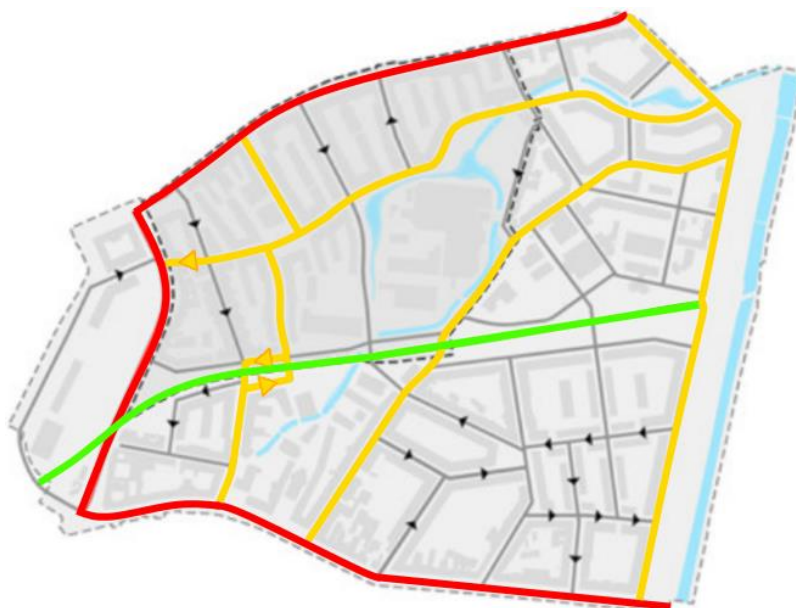
Obr. 13 Cesty první kategorie jsou zaznačeny červeně, druhé žlutě, přičemž parkový koridor vedený podél železniční trati je vyznačen zelenou barvou. Cesty třetí kategorie jsou ponechány šedě. Zdroj: Špitálka, upraveno autorem.
