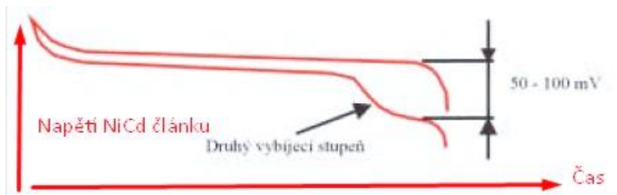
Obr. 3: Vybíjecí charakteristika NiCd článku [6]
