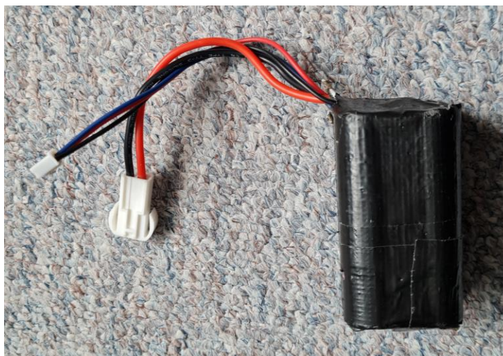
Obr. 63: Měřená LiIon baterie pro RC modely složená ze čtyř článků
