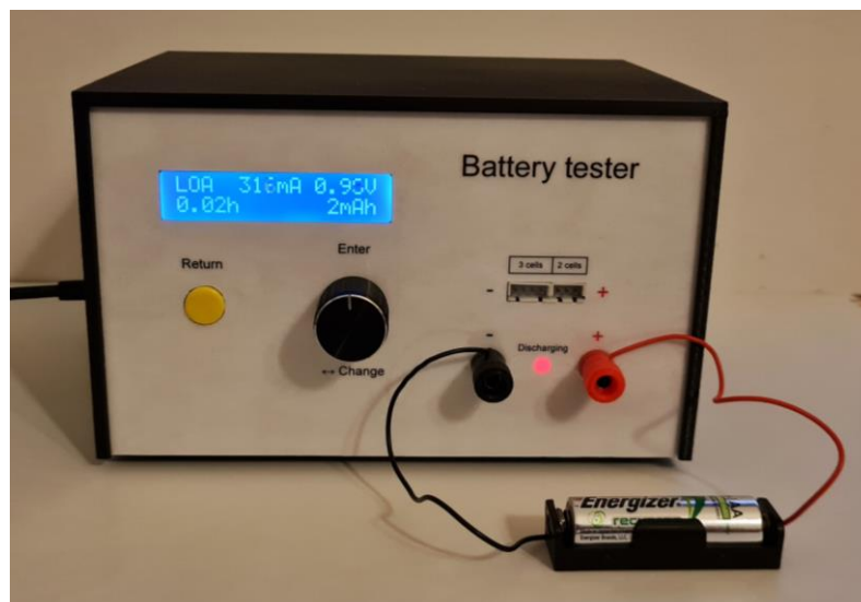
Obr. 56: Připojená AA baterie k testeru při měření zátěžové charakteristiky
