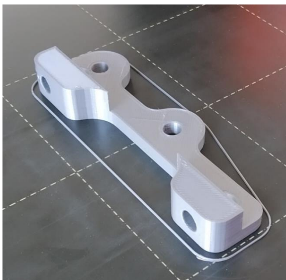
Obrázek 58: Hotový výtisk držáku brzdového třmenu
