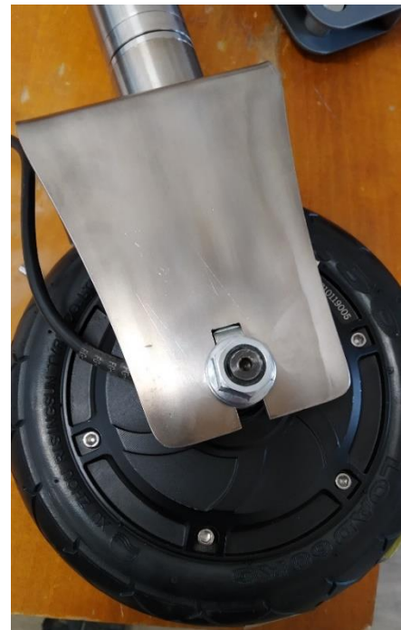
Obrázek 52: Detail uchycení elektromotoru
