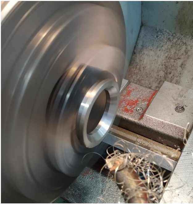
Obrázek 51: Soustružení oběžného kroužku
