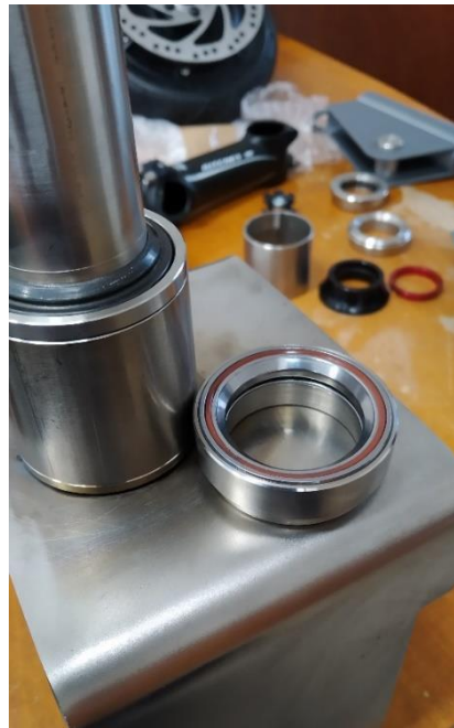
Obrázek 50: Ložisko zalisované v ložiskovém domečku
