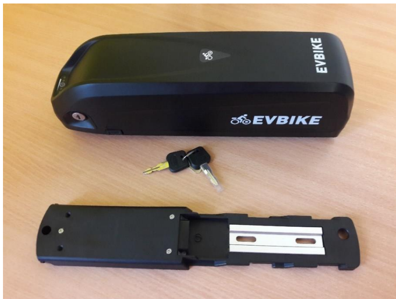
Obrázek 22: Zvolená baterie s přichycením na rám
