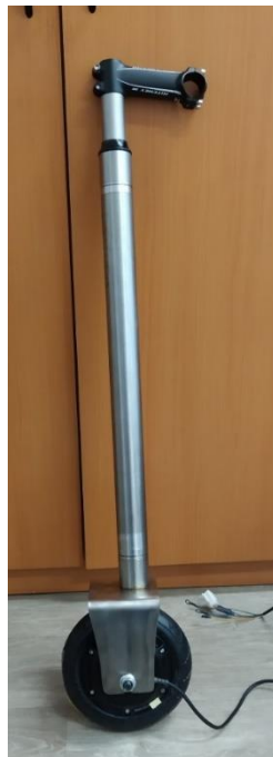
Obrázek 53: zkušební osazení elektromotoru
