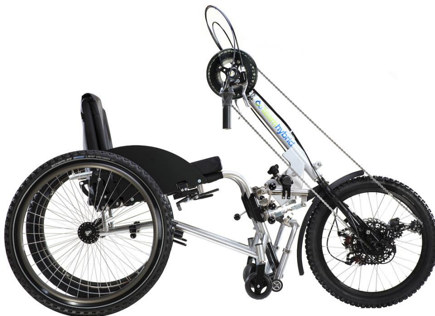
Obrázek 10: Přídatná vidlice s pedály připevněná k invalidnímu vozíku. [13]
