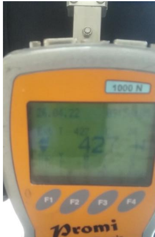
Obrázek 124: Naměřená síla působící kolmo na západku (427 N)
