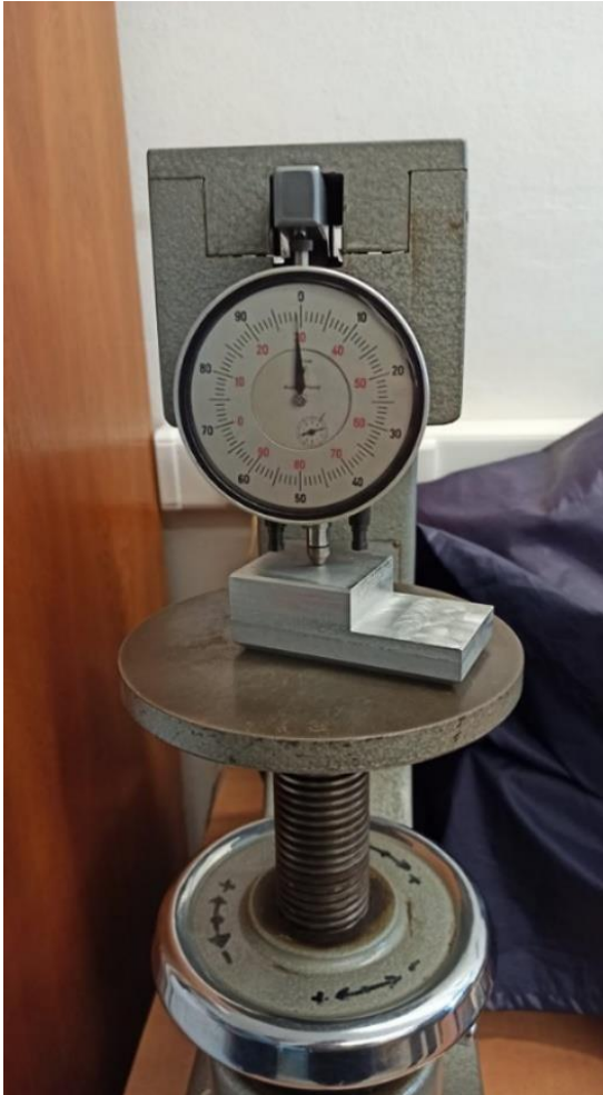
Obrázek 81: Měření tvrdosti HRB – před zatížení
