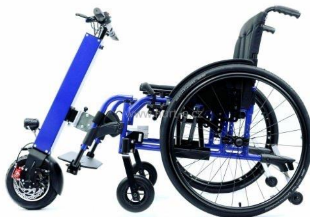
Obrázek 11: Plně elektrický přídatný pohon připojený k invalidnímu vozíku. [14]
