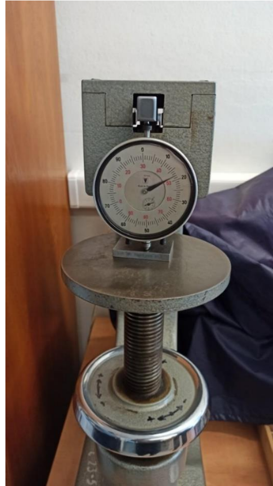
Obrázek 82: : Měření tvrdosti HRB - výsledná tvrdost (26,3 HRB)
