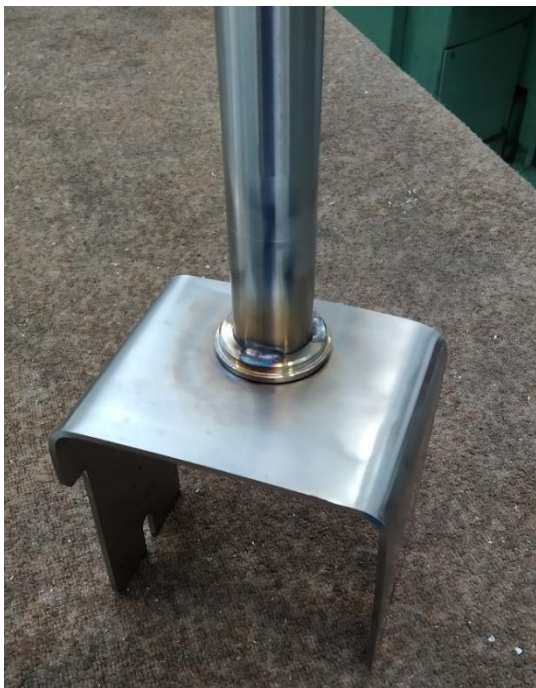
Obrázek 49: Svarek vidlice a trubky ø 30 mm
