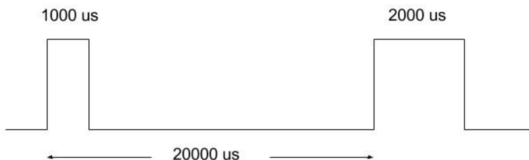
Obrázek 9: Časový průběh PWM signálu (Spsychalski, 2016)
