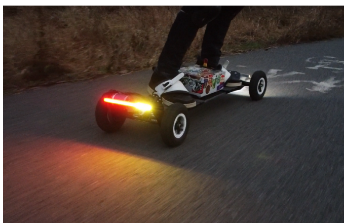
Obrázek 18: Testování směrových světel na elektrickém longboardu
