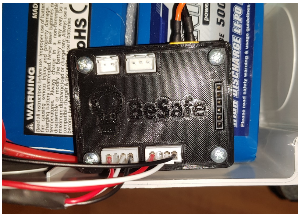
Příloha č. 9: Modul osvětlení v prostoru trakční baterie elektrického longboardu
