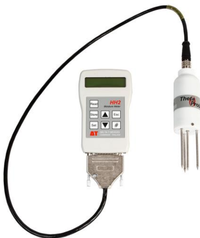
Obr. 7: Měřič vlhkosti půdy HH2 a připojené čidlo ThetaProbe ( https://delta-t.co.uk/product/ml3/# )
