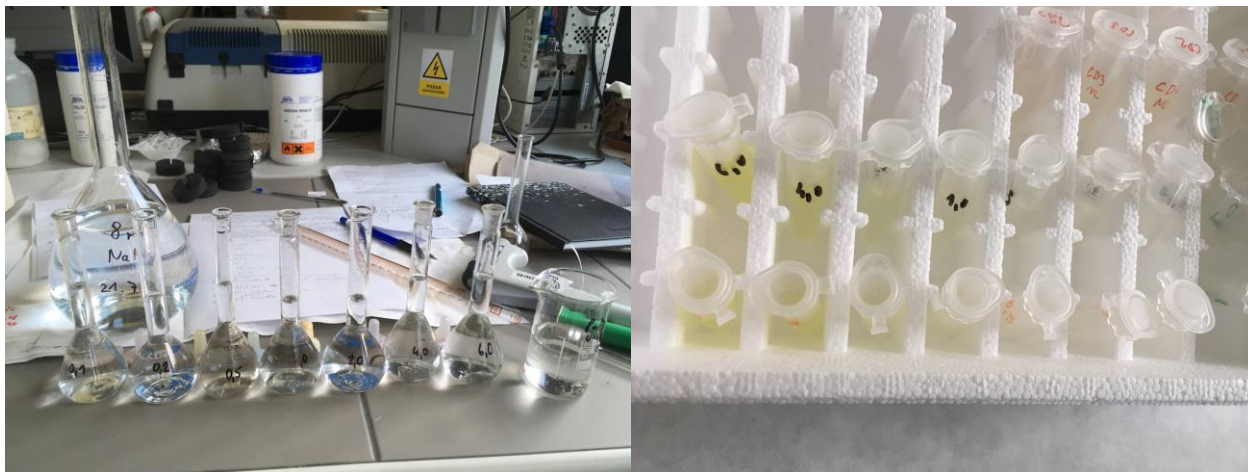
Obr. 12: Kalibrační řada (vlevo), kalibrované vzorky v mikrozkuvkách (vpravo) (foto Alžběta Floriánová, 2021)
