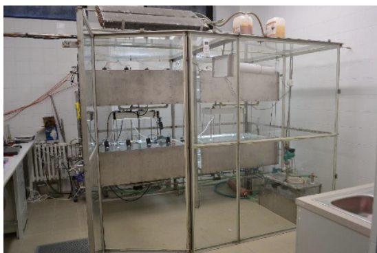
Obrázek 7. Inhalační komora s inhalačními klecemi (foto Eva Svozilová, DiS., Ústav analytické chemie, AV ČR, v.v.i.)
