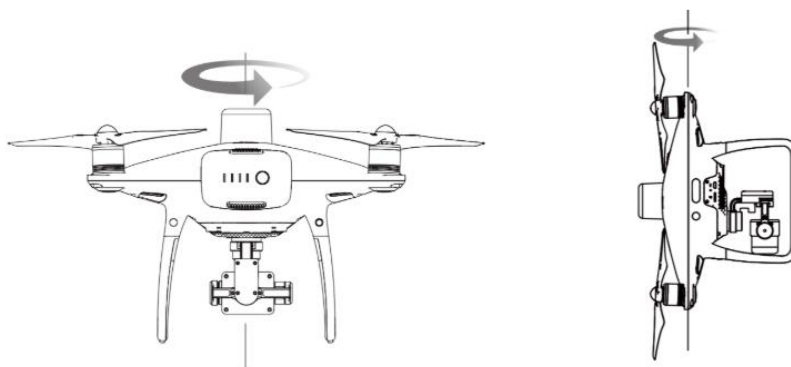
Obr. 14: Osy otáčení při kalibraci kompasu
