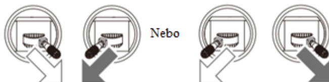
Obr. 19: Pozice páček pro start rotorů dronu
