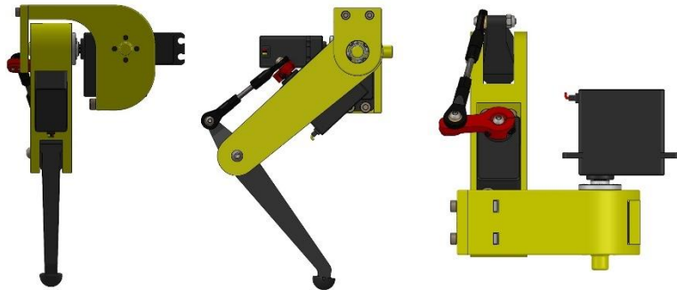
Obrázek 44 – Kolmé pohledy na nohu robota
