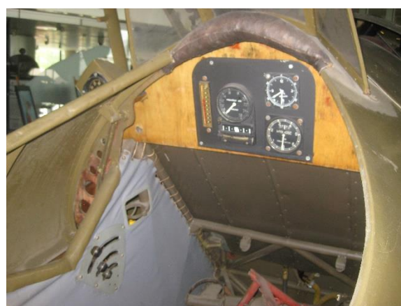
Obr. č. 17: Přední pilotní prostor PWS-26.
