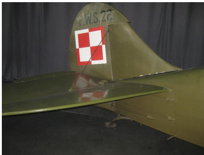
Obr. č. 21: Pohled na svislé a vodorovné ocasní plochy letounu PWS-26.
