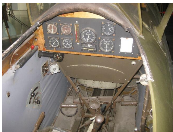
Obr. č. 16: Zadní pilotní prostor PWS-26.
