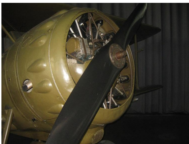
Obr. č. 19: Pohled na zakrytovaný hvězdicový motor letounu PWS-26.
