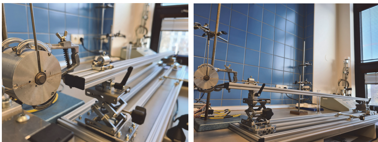
obr. 13 – pojezdová vodící dráha jemně nastavitelná ve všech osách
